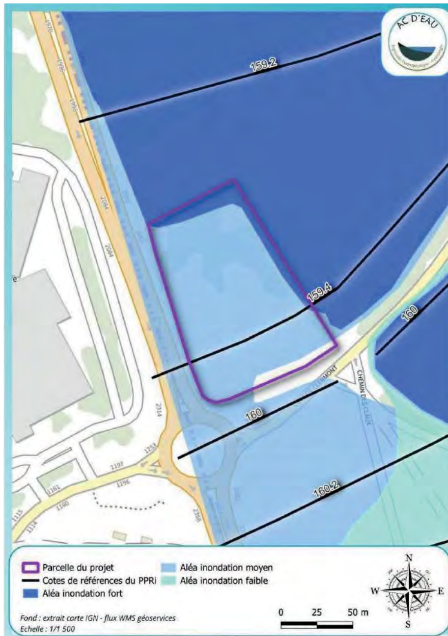
Figure 9 : Aléa du PPRI et cote de référence au niveau du projet (source : AC D'EAU)
